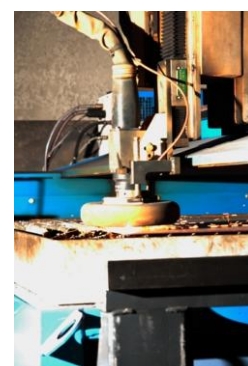
DECOUPE PLASMA 3000 x 1500 mm Epaisseur : 20 mm
