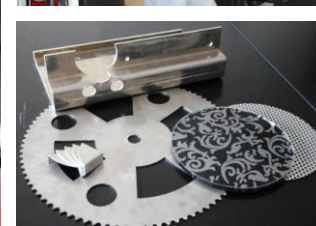
LASER L.3000 x l.1500 mm Epaisseur max : 10 mm
