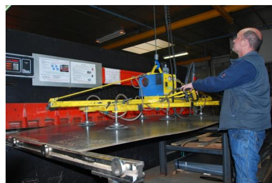
CISAILLE Dimension : 4000 mm Epaisseur max : 6 mm
