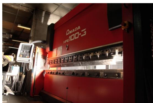
PRESSE PLIEUSE 100 T Dimension : 3000 mm Epaisseur max : 6 mm
